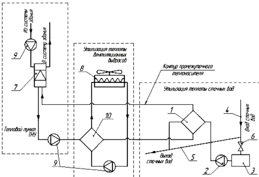
1 – теплообменник-утилизатор теплоты сточных вод; 2 – побудитель циркуляции; 3 – накопительный резервуар; 4 – канализационный стояк; 5 – канализационный выпуск; 6 – затвор канализационный; 7 – теплонасосная установка; 8 – калорифер утилизатора теплоты вентвывбросов; 9 – циркуляционные насосы; 10 – теплообменник-утилизатор теплоты вентвывбросов.
