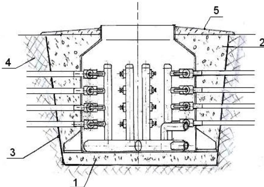
1 – песчано-щебеночная подсыпка 100 – 150 мм; 2 – песчано-щебеночная обратная засыпка; 3 – фильтрующий материал (стеклохолст, «Тайпар» и т. п.); 4 – основной грунт; 5 – отмостка.
