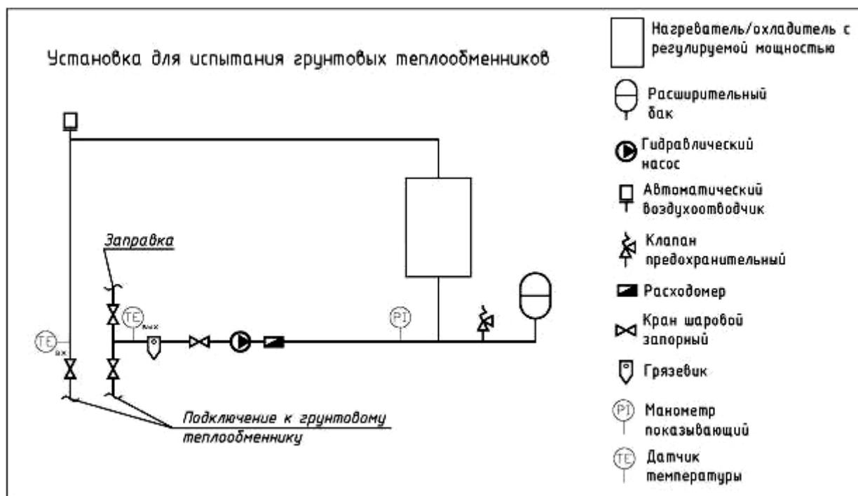
Рисунок В.1 – Пример схемы установки для проведения тепловых испытаний грунтовых теплообменников
