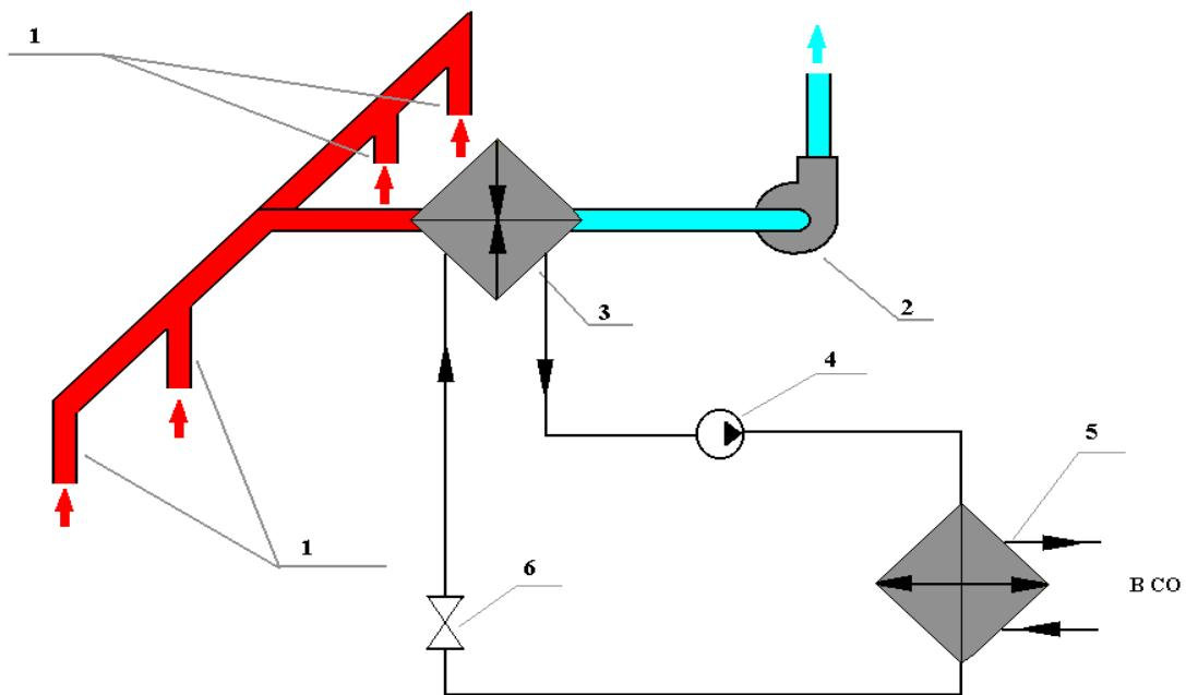
1 – вытяжные шахты; 2 – вытяжной вентилятор; 3 – испаритель-утилизатор; 4 – компрессор; 5 – конденсатор; 6 – регулирующий вентиль. Обозначение СО – система отопления.
