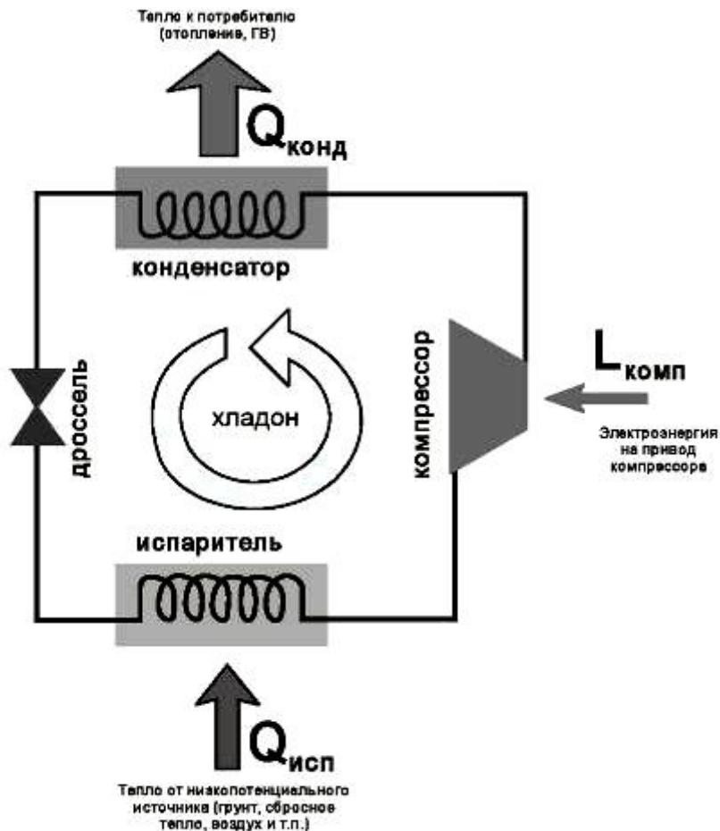
Рисунок А.1 – Принципиальная схема парокомпрессионного контура теплового насоса
