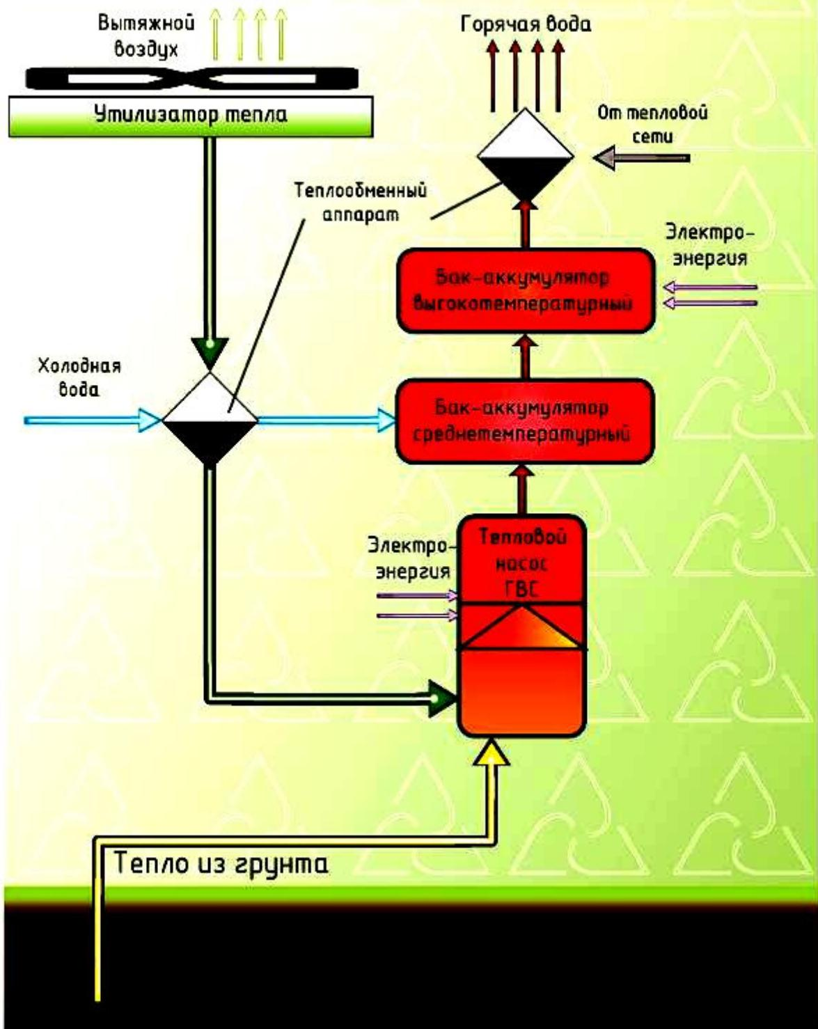
Рисунок 9 – Комбинированное использование теплоты вентиляционных выбросов и грунтового массива
