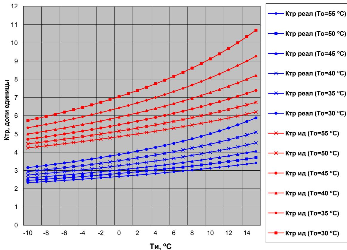
Рисунок А.2 – Типичный вид зависимости идеального и реального коэффициента трансформации энергии парокомпрессионных тепловых насосов от температур испарения и конденсации хладагента
