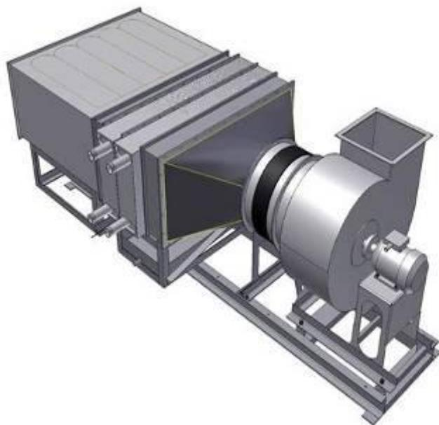
Рисунок 3 – Общий вид агрегата утилизации теплоты вентиляционных выбросов
