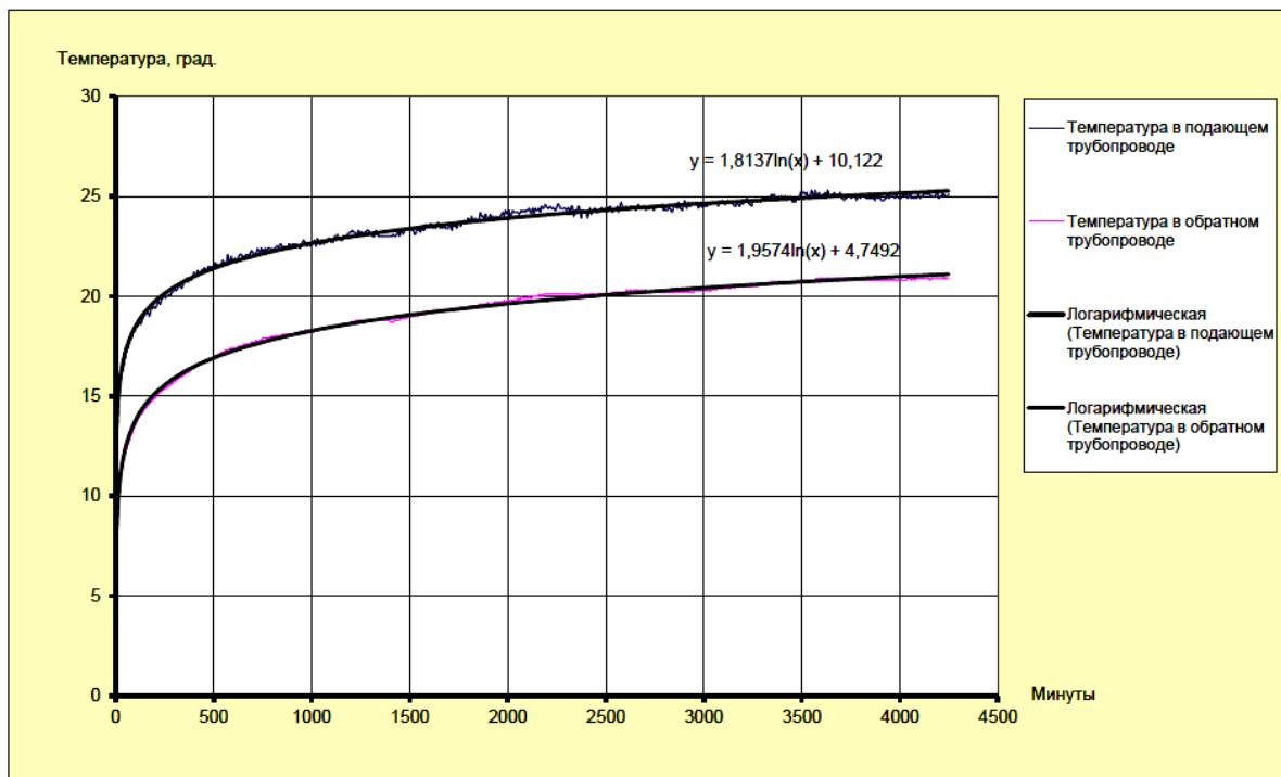
Рисунок В.3 – Логарифмическая аппроксимация трендовыми линиями графиков температуры в подающем и в обратном трубопроводах
