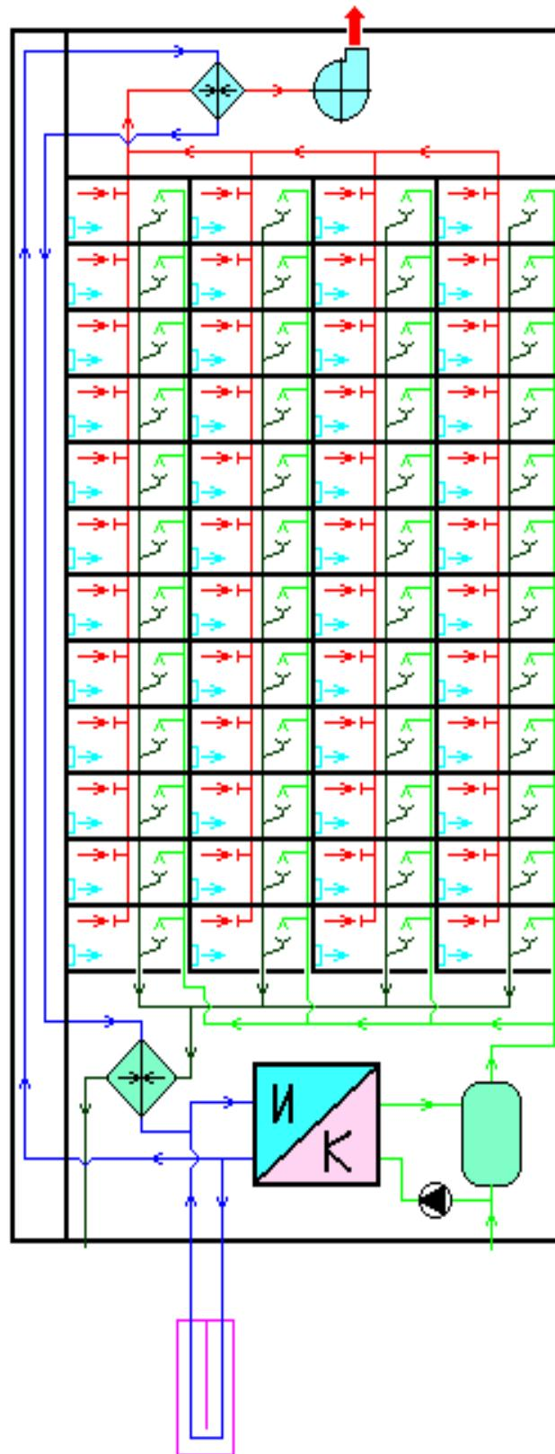
Рисунок 10 – Комбинированное использование теплоты вентвыбросов, грунта и канализационных стоков жилого дома
